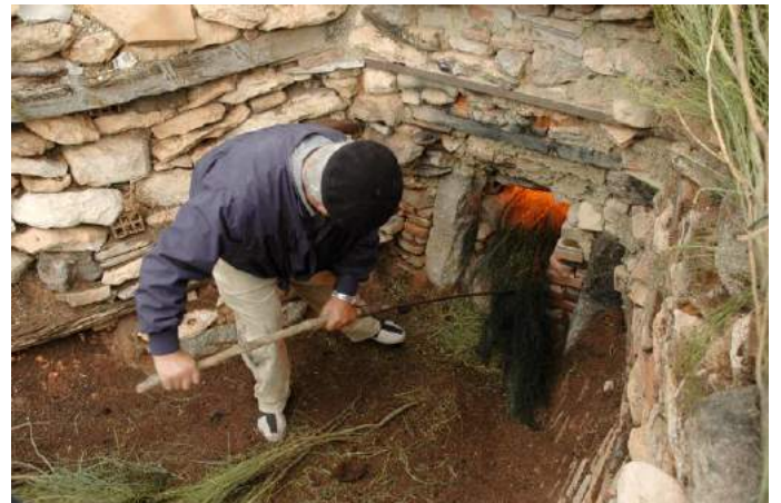
Alimentando el horno con retama ayudado de la "horquilla"
