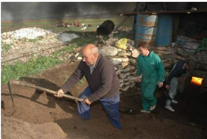
El "servidor", rampa que facilita el acceso a la boca del horno
