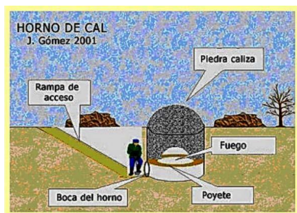
Figura 1.- Esquema del horno de cal.
